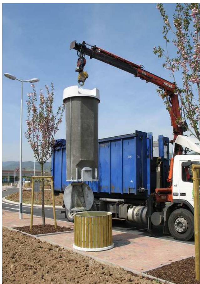
Obrázek 4-5 – ukázka vyprazdňování 3 a 5m 3 podzemního kontejneru.
