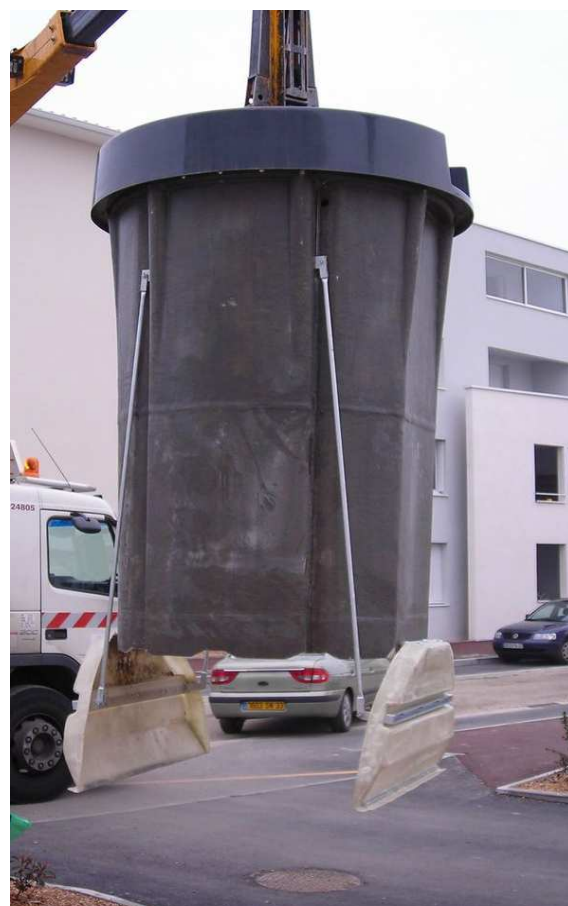
Obrázek 4-5 – ukázka vyprazdňování 3 a 5m 3 podzemního kontejneru.
